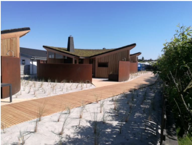
Billede 3: Eksisterende campinghytter i cortenstål og hårdt træ med sedum på taget, kaldet Lærkereder .
